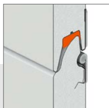
Panel grubości 40 mm. U=1,0 [ W/m^2K ]*.
