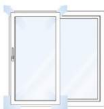
Skrzydło odstawione od ramy o ok. 6 mm.
